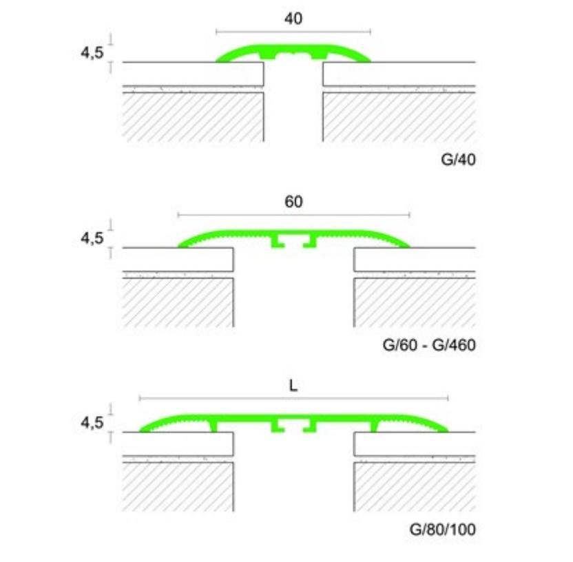
Tapajunta de aluminio anodizado de ancho 40,60 y 80 mm.
