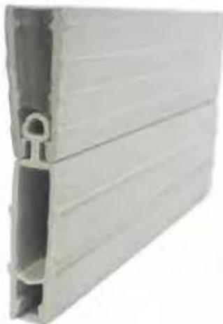
Junta de dilatación de PVC Coextruido que permite el pulido en obra, adecuada para instalación de pavimentos con mortero de espesor de 5 a 7 cm , terrazos, mármoles, etc.
