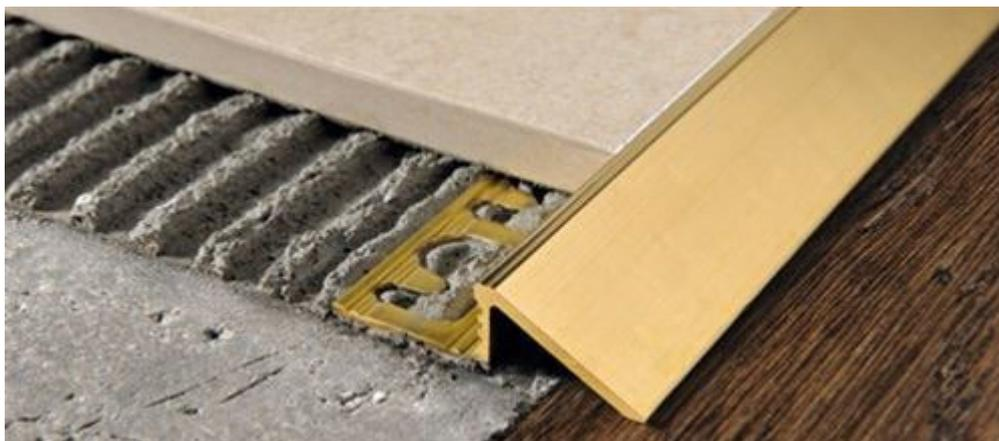
El perfil Slider latón de la serie Desnivel es un perfil de transición para aplicar durante la colocación de la cerámica o el mármol y sirve para unir pavimentos de diferente espesor y salvar el desnivel.
